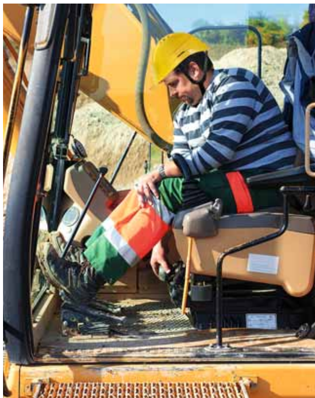
Foto 19 I sedili di guida ammortizzanti devono essere regolati in base al peso del conducente.
