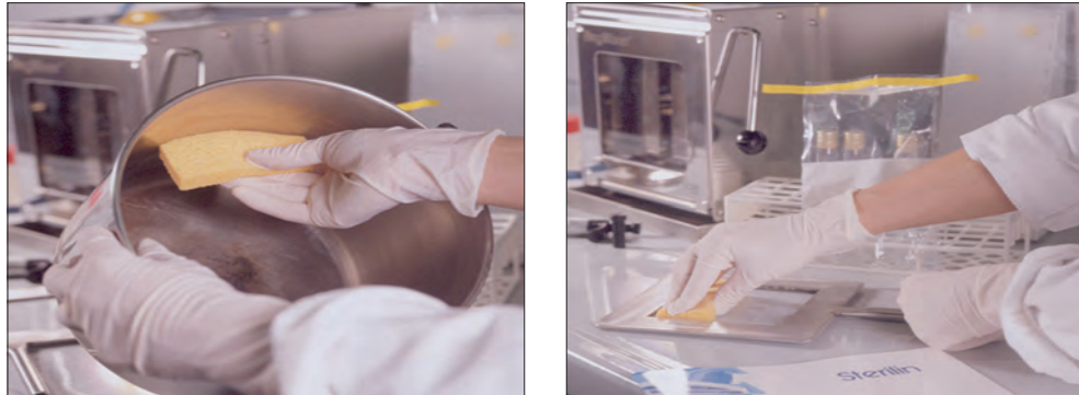
Figura 7 - Campionamento con la metodica sponge-bag
