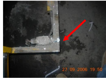
Particolare sensore di blocco sportello non idoneo
