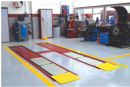
ponte sollevatore elettroidraulico a forbice
