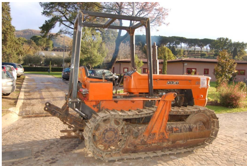
Figura 19. Struttura di protezione per trattori a cingoli modello Fiat 805 C e simili
