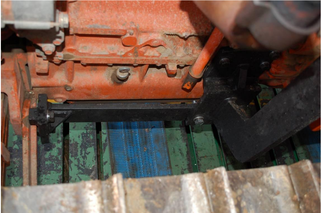
Figura 10. Traversa anteriore e dispositivo di attacco anteriore lato sinistro.
