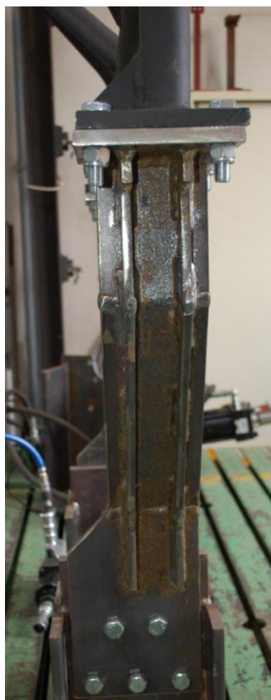
Figura 7. Dispositivo di attacco anteriore lato sinistro (a sinistra) e dispositivo di attacco posteriore lato destro (a destra).
