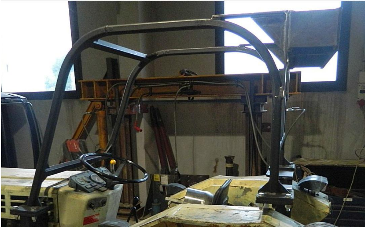
Figura 8. Telaio di protezione a quattro montanti a profilo compatto (CROPS).
