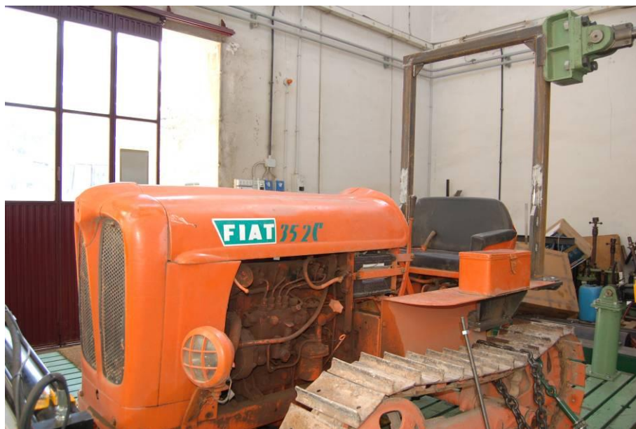
Figura 11. Struttura di protezione per trattori a cingoli modello Fiat 352C e simili
