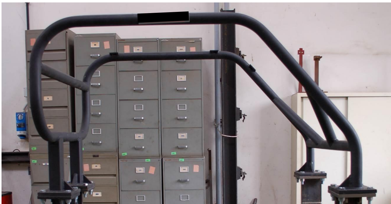
Figura 6. Telaio di protezione a quattro montanti a profilo compatto (CROPS).
