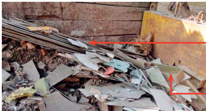
Lastre per tetti, fioriere e parti di tubi in fibrocemento tra i rifiuti misti
