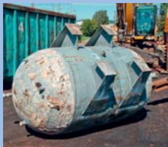
Isolamento di una caldaia
