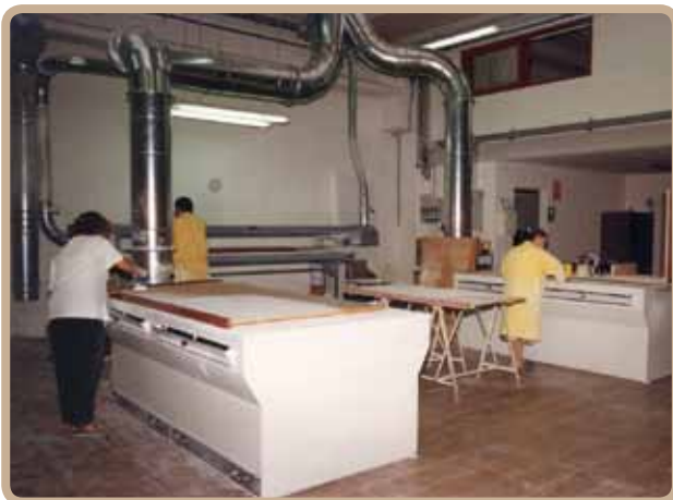
Figura 17: Banchi aspiranti per carteggiatura con aspirazione a bordo.
