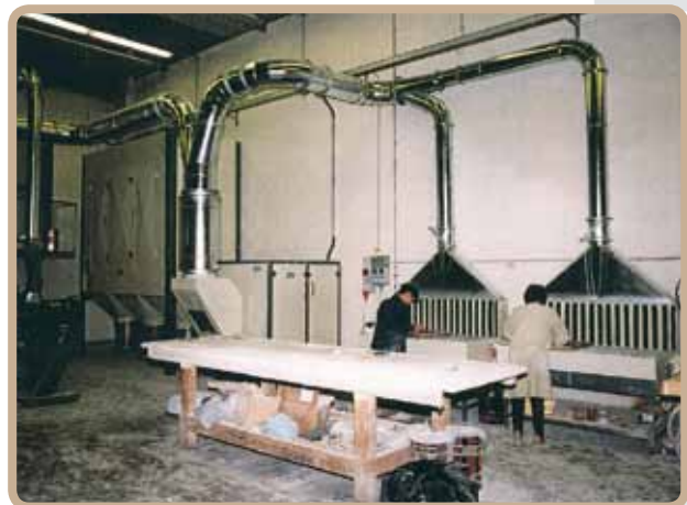
Figura 18: Banchi aspiranti con parete frontale per carteggiatura.
