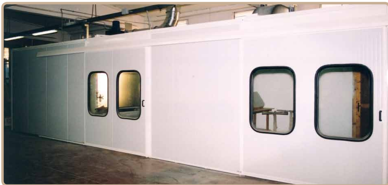
Figura 25: Cabina di verniciatura pressurizzata con essiccoio.
