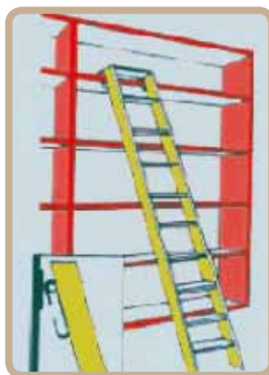
Figura 2: Dispositivi di trattenuta/antiscivolo all'estremità superiori.
