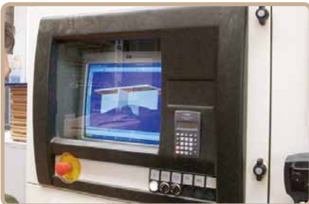
Figura 15: Ufficio tecnico del reparto Pantografatura dotato di software CAD/CAM che elabora e crea programmi di lavorazione alla base della realizzazione dei singoli pezzi.
