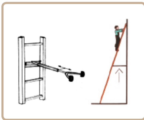
Figura 3: Dispositivo che impedisce l'apertura della scala oltre il limite prestabilito di sicurezza.
