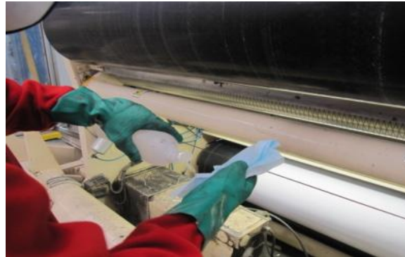
Foto 2: fase di pulizia della tagliarina
