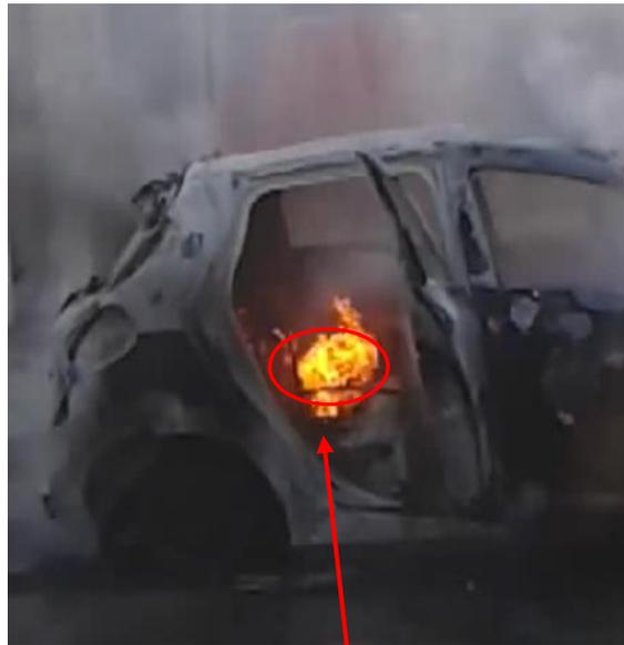
Pacco batterie con coperchio termofusibile (Fire-access),
