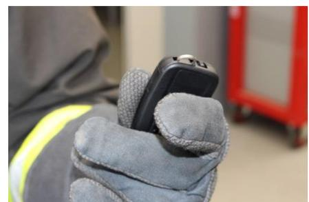
2. Scollegare la connessione di sicurezza della batteria alta tensione (sempre presente su queste macchine e che separa fisicamente il pacco batterie) utilizzando guanti isolanti,
