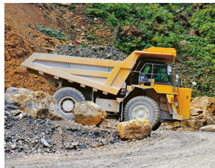
8 Una guida attenta, previdente e non veloce aiuta a contenere le vibrazioni quando si circola su un terreno accidentato.
