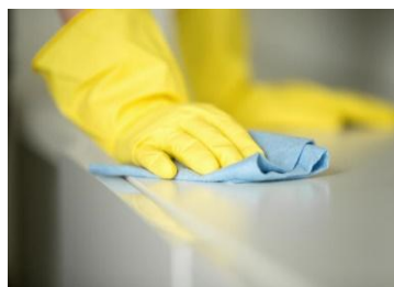
Foto 3 Metodo corretto per la pulizia e sgrassaggio mediante utilizzo di straccio imbevuto di solvente e guanti
