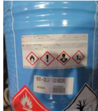
Foto 2: Fusto del solvente infiammabile di cui era impregnato lo straccio per la pulizia
