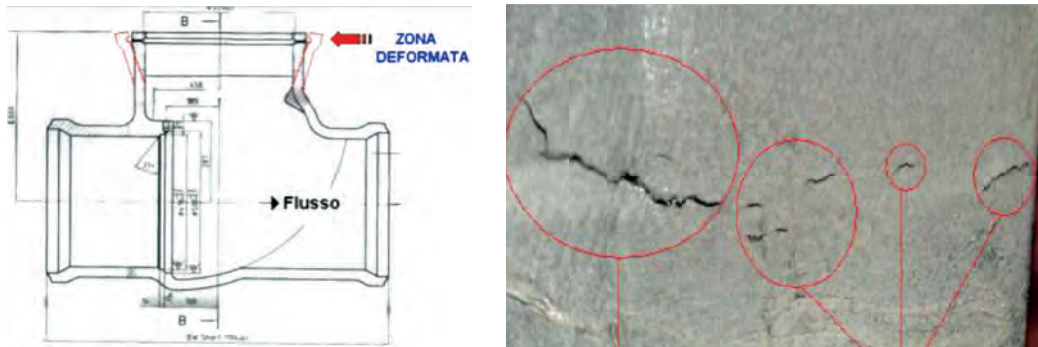
Figura 23. Zona della valvola deformata con cricche
