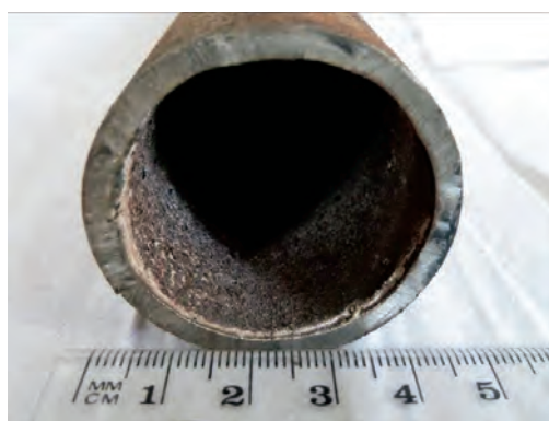
deposito sulla superficie interna
