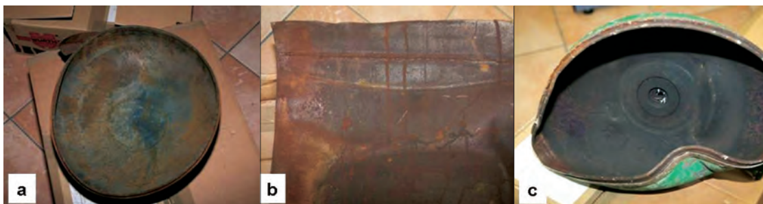
Figura 28. Panoramica dei reperti: fondo (a), corpo cilindrico (b) e calotta (c)
