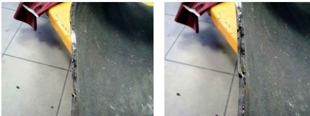
Figura 5. Alcune fotografie scattate in occasione dell'esame visivo di una bombola che ha subito una rottura per tensocorrosione: si noti il doppio strato lungo la linea di frattura
