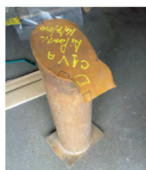
primo punto di rottura: base del supporto
