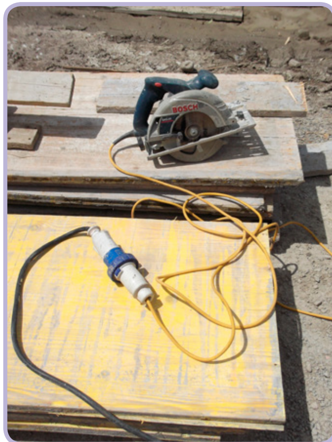
Figura 29: Seghetto - presa a spina IP 67.
