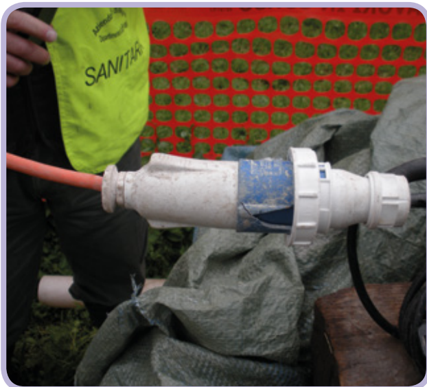
Figura 56: Presa a spina di una prolunga rotta.
