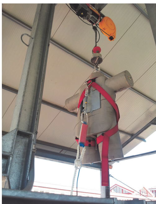
Figura 4.2.1-6 Posizione iniziale (Fase 1)
