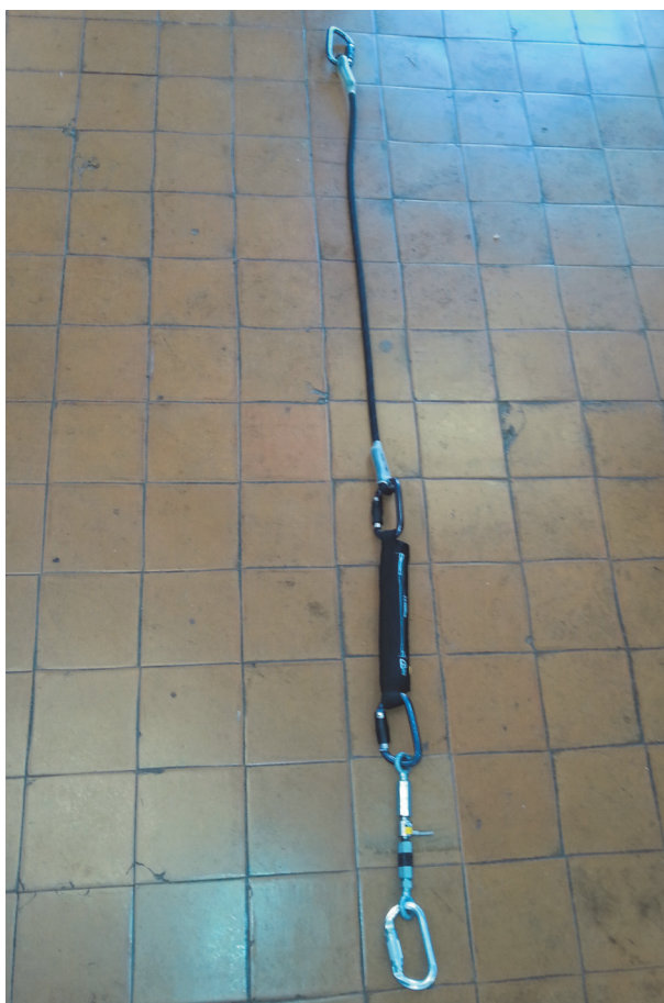
Figura 4.2.2.2-1 Sistema di collegamento F
