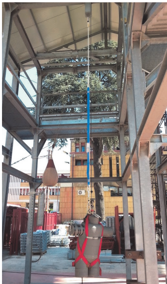
Figura 4.2.1-9 Posizione finale (Fase 4 - si noti l'assorbitore svolto)
