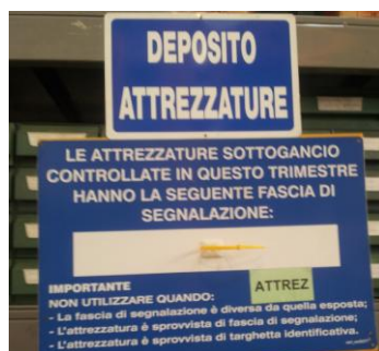
Figura 12 esempio di rastrelliera indicante, secondo un approccio cromo-temporale dei controlli, la colorazione dell'accessorio di sollevamento da utilizzare per il trimestre in corso. In particolare, si evidenzia il codice attribuito all'accessorio di sollevamento al fine di associare in modo univoco lo stesso con il registro di controllo per la manutenzione.
