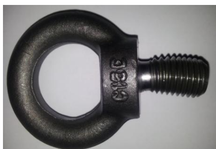
Figura 15 esempio di golfare avente gambo filettato deformato. In questo caso è necessario rottamare il componente.
