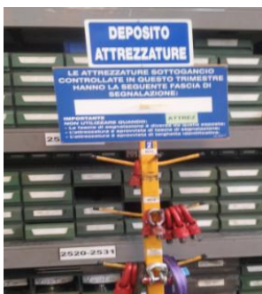
Figura 12 esempio di rastrelliera indicante, secondo un approccio cromo-temporale dei controlli, la colorazione dell'accessorio di sollevamento da utilizzare per il trimestre in corso. In particolare, si evidenzia il codice attribuito all'accessorio di sollevamento al fine di associare in modo univoco lo stesso con il registro di controllo per la manutenzione.
