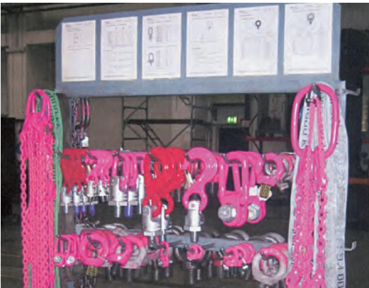
Figura 11 esempio di rastrelliera per il deposito dei golfari riportante anche le istruzioni operative per l'uso dei golfari
