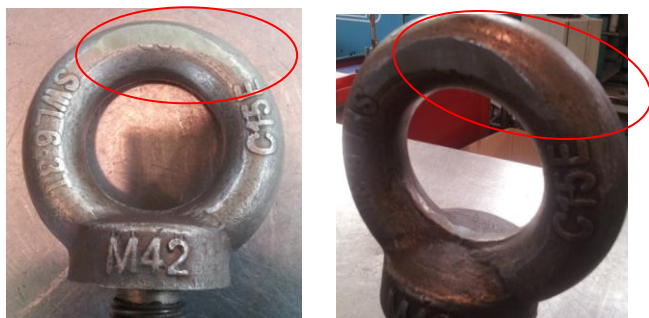
Figura 13 esempi di abrasioni eseguite sui golfari. Tali manovre comportano una riduzione della sezione resistente pregiudicando la sicurezza dell'accessorio di sollevamento. In questo caso è necessario rottamare il componente.
