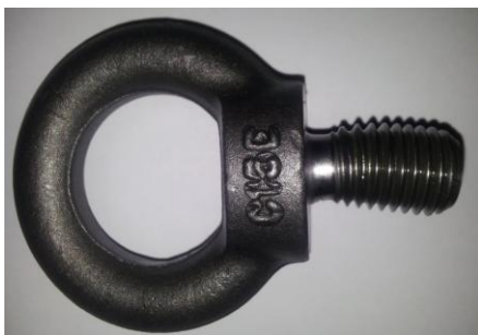
Figura 2 esempio di golfare avente gambo filettato deformato
