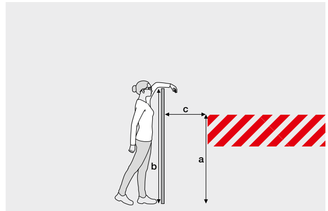
Distanze di sicurezza relative all'accesso oltre strutture di protezione (ad es. recinzioni protettive)
