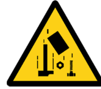
Pericolo caduta materiali
