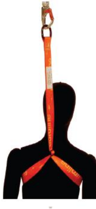
Fig. 11. Cinghia di salvataggio di classe A . La cinghia è dichiarata dal costruttore non adatta a salvare persone inincosce. PRODUTTORE euroline® marchio A. HABERKORN & CO. GMBH; Freistadt http://www.a-haberkorn.at/
