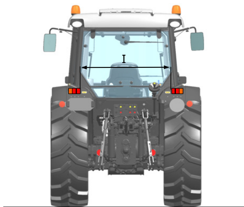
Fig. 22. Posizione in larghezza delle luci di arresto.
