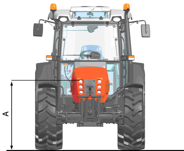
Fig. 14. Posizione in altezza dei proiettori anabbaglianti
