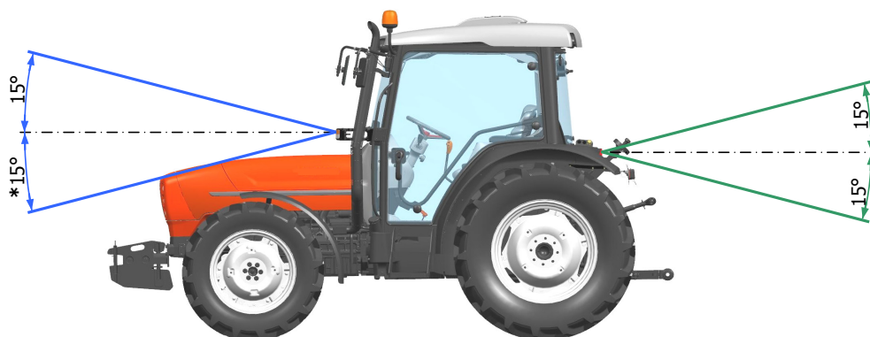
Fig. 21. Angoli verticali degli indicatori di direzione
