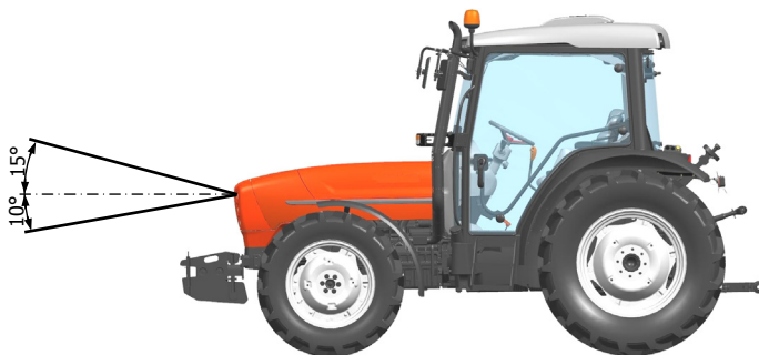
Fig. 16. Angoli verticali dei proiettori anabbaglianti
