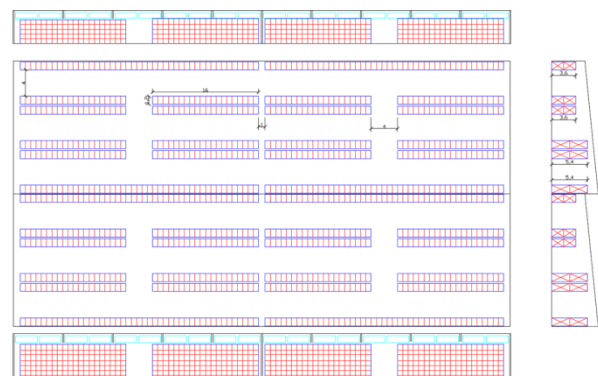
Fig. 13 - Deposito: scaffalature e aree di deposito di materiale di tipo celluloso
