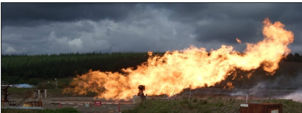
Fig. 3. – Prova di resistenza al jettfire in grande scala
