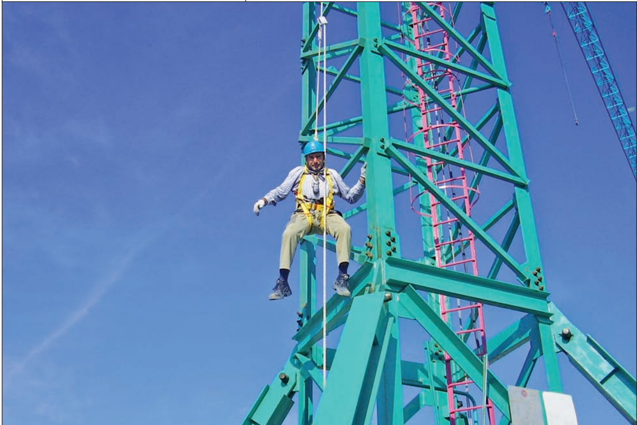
Sospensione passiva con attacco dorsale
