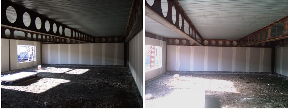
a) Il compartimento di prova con travi alveolari non protette di grande luce
