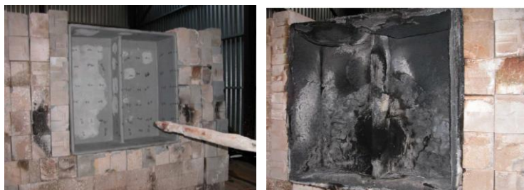
Fig. 8. – Prova di resistenza al fuoco – Jet fire (ISO 22899-1)
