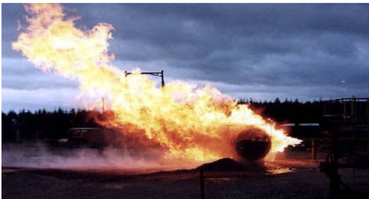
Fig. 9. – Prova di resistenza al fuoco di un serbatoio in scala reale (BAM)
